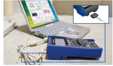
측정값을 현장에서 PC 에 저장 및 확인 통신 패키지 DT4900-01 (옵션)을 사용
